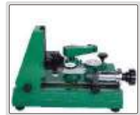
deneme komparatörün doğruluğunu kontrol etme
