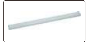
300mm kalibrasyon skalası (50mm kalibrasyon skalası ile büyütme doğruluğu kontrol edilir ya da ölçüm hassasiyeti kalibre edilir)
