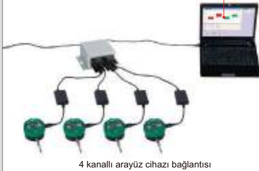
4 kanallı arayüz cihazı bağlantısı
