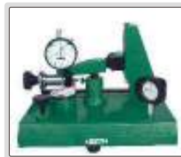
yanal kuvvetin komparatör saatinin doğruluğu üzerindeki etkisini denemek (yarım yuvarlak blok master gereklidir)
