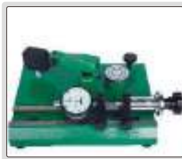
komparatör saatin doğruluğunu kontrol etme (aralık 0-25mm)
