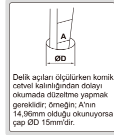
delik açısı ölçümü
