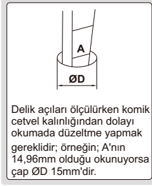
delik açısı ölçümü
